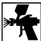
Наносите краскопультom с соплом  $\varnothing 1,2$ - $\varnothing 1,3$  мм при давлении воздуха от 2 до 2,5 бар.
